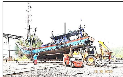
Limbungan Perlis Marine Engineering Sdn. Bhd. - Penggunaan Serentak Backhoe Dan Forklift Untuk Menempatkan Bot (13.10.2016)
