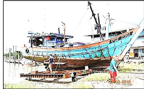
Limbungan Perlis Marine Engineering Sdn. Bhd. - Penggunaan Cradle Untuk Mendaratkan Bot (13.10.2016)
